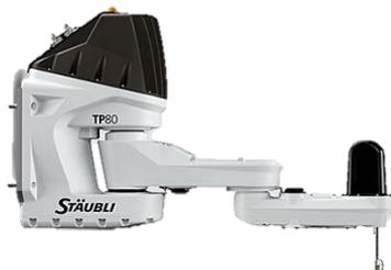
L'emballage des pièces est effectué par un robot Staubli TP80. Le robot doit être entièrement reprogrammé afin d'optimiser son rendement. La programmation s'effectue en Langage VAL3 directement sur l'IDE proposé par Staubli.
